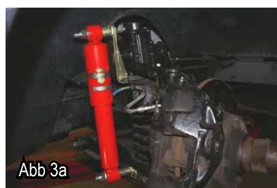
Abb 3 Befestigungspunkt bzw. Bohrung Clip Bremsleitung Point de fixation pour eperage du collier de la durite de frein Mounting 'p'-Clip brake hose
