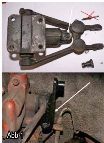
Abb 1 Befestigung obere Montageplatte Fixation de la plaque de montage supérieure Upper mounting plate
