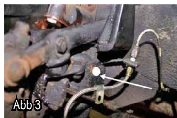
Abb 3 Befestigungspunkt bzw. Bohrung Clip Bremsleitung Point de fixation pour eperage du collier de la durite de frein Mounting 'p'-Clip brake hose
