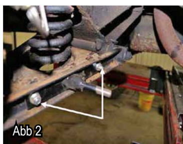
Abb 2 Befestigung untere Montageplatte Fixation de la plaque de montage inférieure Lower mounting plate
